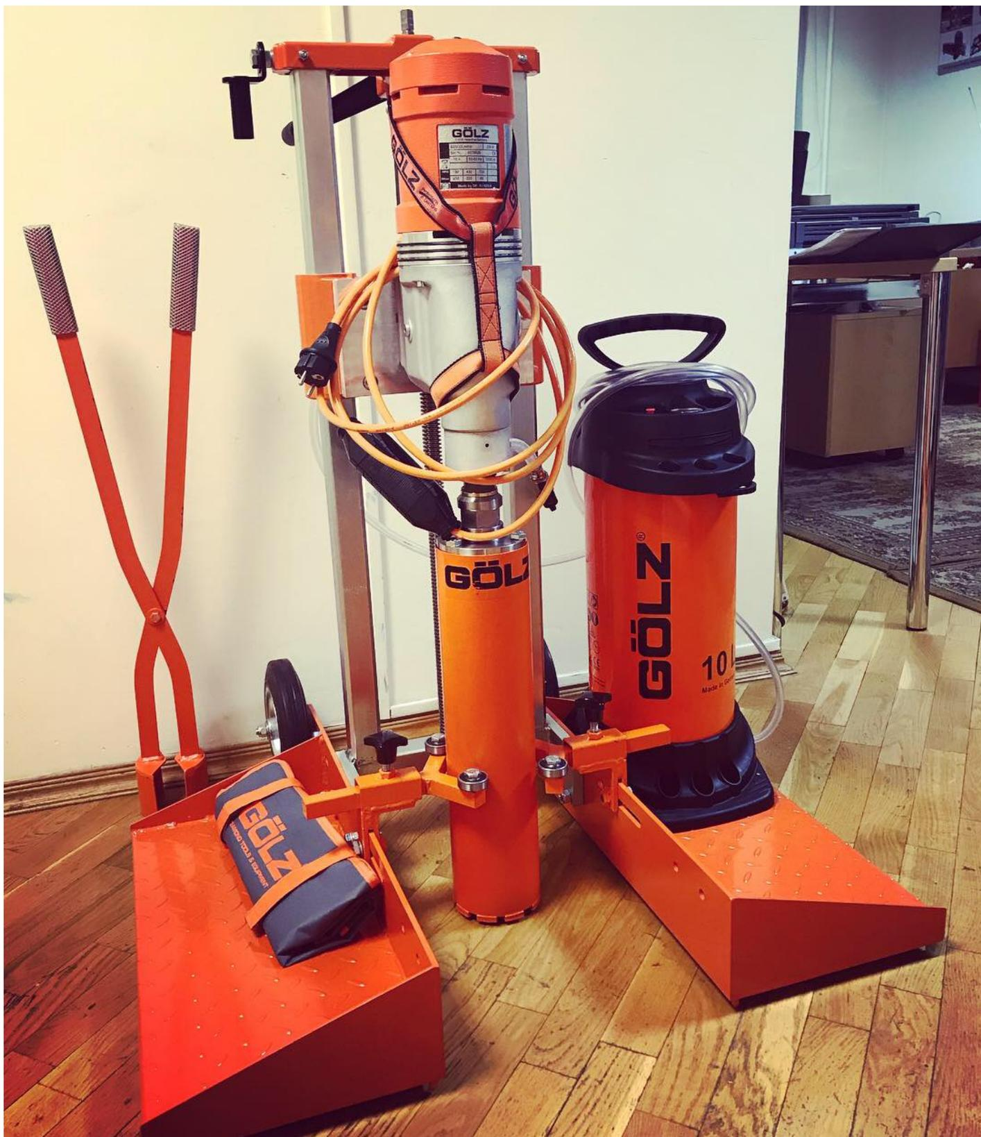
Машина кольцевого сверления KB200 предназначена для отбора кернов из асфальтовых и бетонных покрытий, а также данная установка используется при ремонте и строительстве взлетно-посадочных полос.
