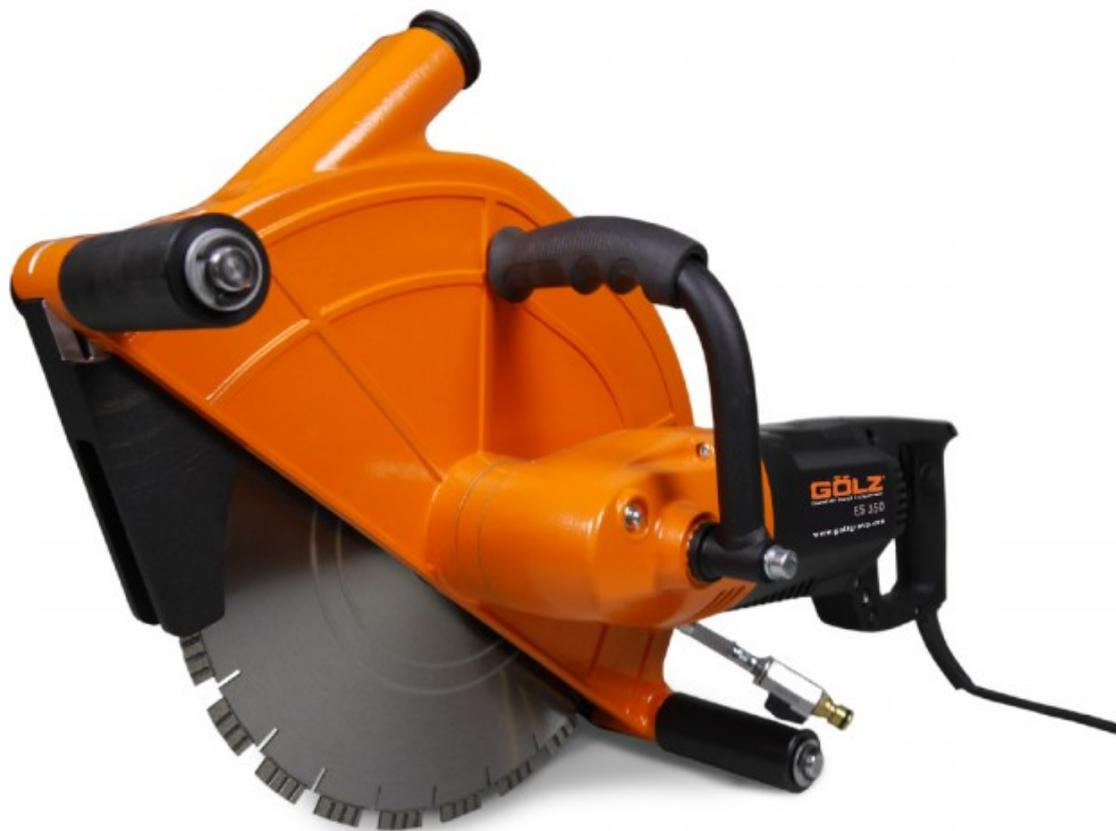
Электрическая отрезная шлифовальная машина для сухого и мокрого шлифования с отсосом. Универсальная пила для выполнения точных разрезов с алмазными отрезными дисками внутри и снаружи. Глубина резки до 130 мм. Мощная электрическая шлифмашина 2,7 кВт для пильного полотна Ø 350 мм и защитного кожуха с отсосом. Пильное полотно противоположного вращения обеспечивает оптимальный отсос грязи при мокрой и сухой резке посредством подключения промышленного пылесоса.
