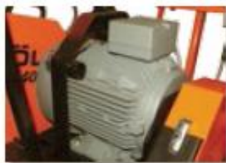
Двигатель снимается с помощью быстро-разъемной системы
