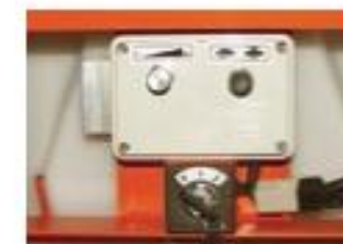
Электростартер + панель управления
