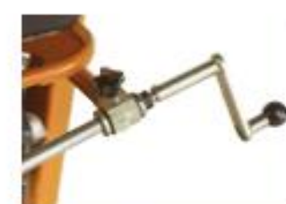
Снижение при помощи кривошипной рукоятки
